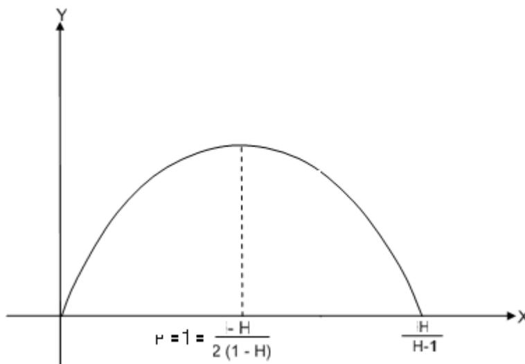
Desse modo, teríamos como ponto máximo  $r = 1$ , que é ponto médio das raízes  $r = 0$  e  $r = \frac{H}{H-1}$ , ou seja,  $1 = r = \frac{H}{2(H-1)}$ , mas se  $r = 1$ , o cilindro estaria degenerado, pois teríamos  $h = 0$  e, portanto, seria somente um disco.
