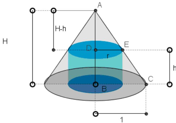
Considerando o raio do cone fixo igual a 1, a altura do cone  $H$ , queremos determinar as possíveis dimensões do cilindro raio ( $r$ ) e altura ( $h$ ), para que o cilindro tenha área máxima em função do cone.
